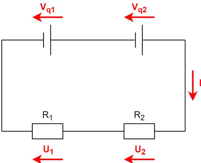
$$V_{q1} + V_{q2} = U_1 + U_2$$
